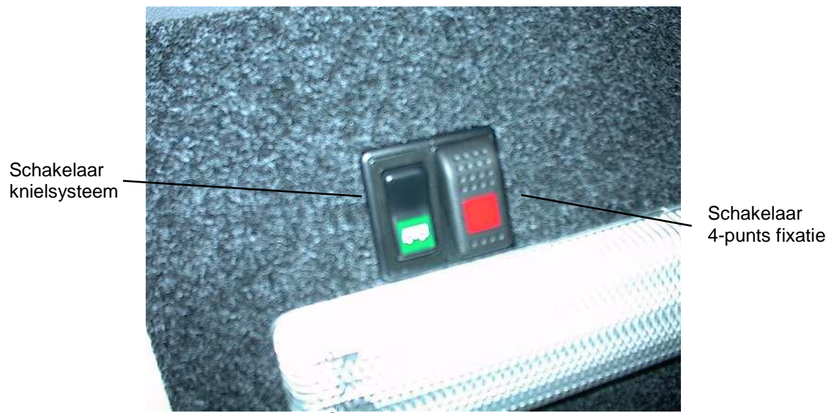
Fig. 1 Schakelkast achter in de auto
