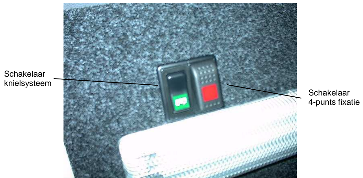
Fig. 1 Schakelkast achter in de auto
